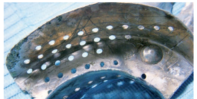
►Fig. 2: vistosi segni di corrosione su un cucchiaino porta-impronta causati da uso improprio (tempo di contatto e/o concentrazione) di prodotti per togliere il gesso. Vanno subito eliminati. La loro presenza durante una delle fasi del ricondizionamento di altri strumenti odontoiatrici può portare alla loro corrosione
